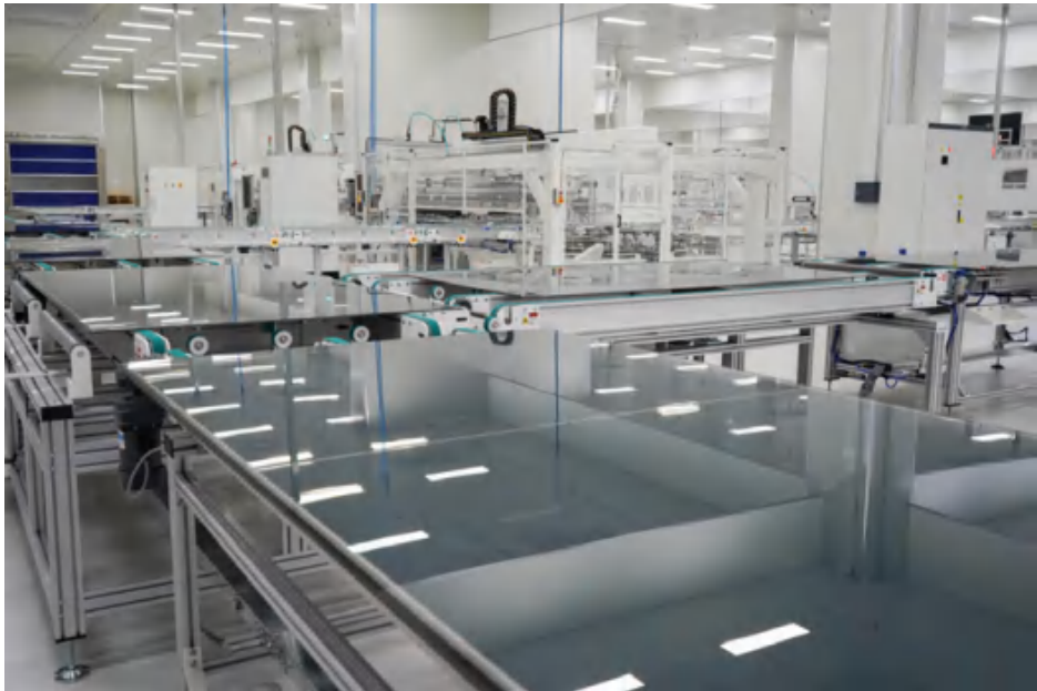
图 95: 极电光能 GW 量产线 2.8 平方米钙钛矿组件首片下线，供图：极电光能 61
