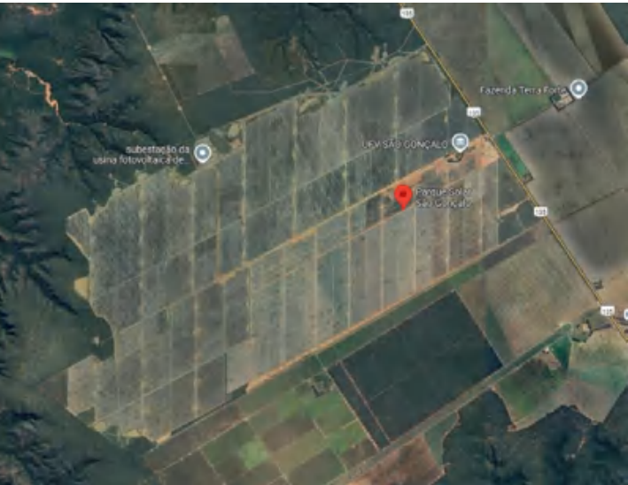
图 86: 巴西 São Gonçalo 太阳能发电项目，总装机容量达到 864 兆瓦，年发电量达 2 太瓦时，是拉丁美洲最大的太阳能发电项目，每年可减少 130 万吨二氧化碳排放。 55
